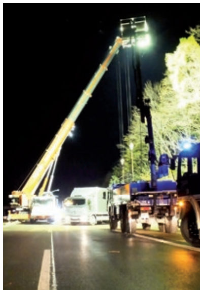
Mit Spezialgerät wie hier einer Beleuchtungstraverse mit 10.000 Watt, unterstützt das THW Kitzingen die Rettungsorganisationen und die Polizei im Landkreis Kitzingen
